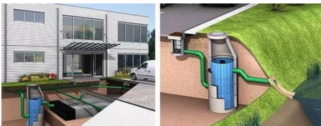
Figura 12- Tanques de armazenamento de águas pluviais
