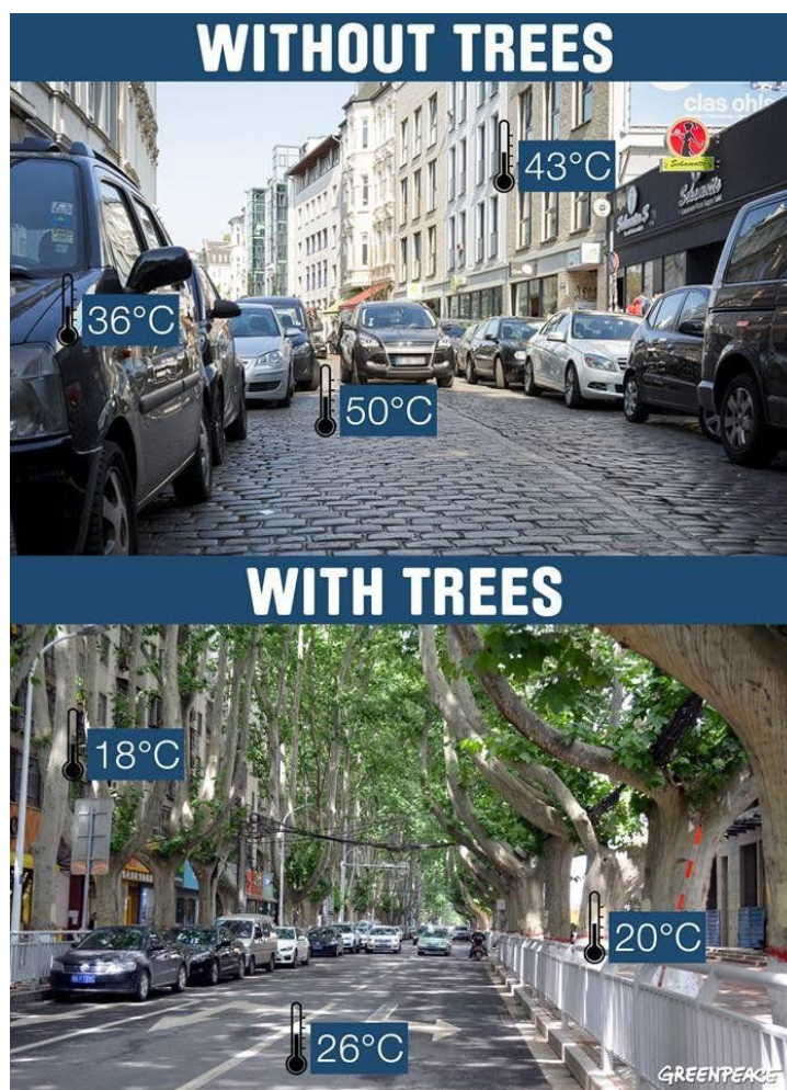
Figura 22- Diferentes temperaturas do ar ao nível do solo, conforme a existência de vegetação e o tipo de material de pavimentação (Fonte: Pinterest )
