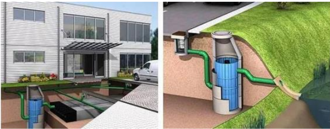
Figura 12- Tanques de armazenamento de águas pluviais
