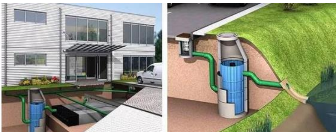
Figura 12- Tanques de armazenamento de águas pluviais
